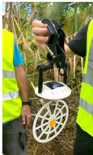
Balises « Raptor Clamp LED » expérimentées sur 2 tronçons de lignes HTB aériennes
