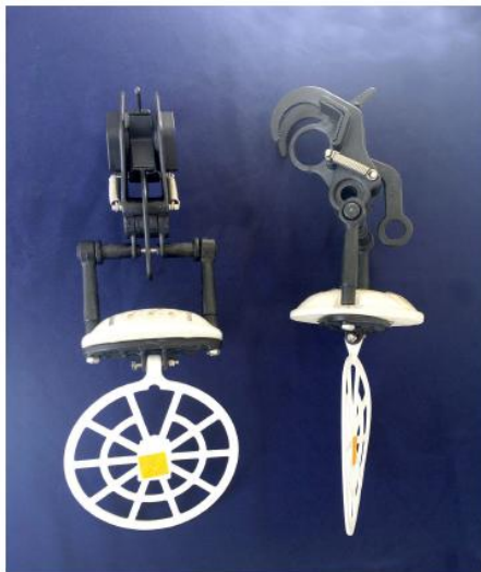
Balises « Raptor Clamp LED » expérimentées sur 2 tronçons de lignes HTB aériennes
